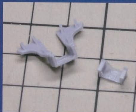
▲ハイパーカットソーを使うとパーツの割れなど一切なく切断面もきれいなので、パーツに近い場所で一気に切り落とすことも可能だ。
