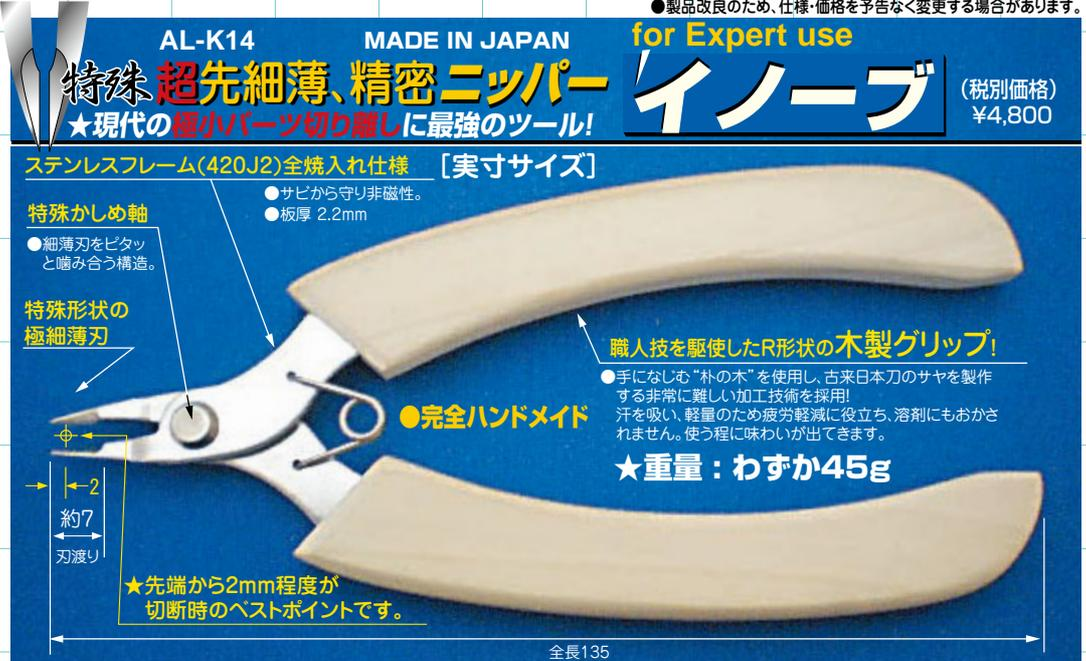
◆刃先を通常の板物のニッパーより薄く、細く、長い仕様となっています。刃付け部分は通常平均より+0.5mm長。細く、狭い隙間の繊細なプラモデルのゲートのカットに威力を発揮します。エッチングパーツの様な曲りやすい物のゲートも薄刃のため、曲る事無くカットが可能。細い棒状の極小パーツをゲートから切り離す時も刃の厚みでパーツを押し曲げる事も無いのでそれ自体を变形させない構造となっています。
